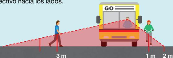
Puntos ciegos del conductor de un colectivo hacia el frente.
