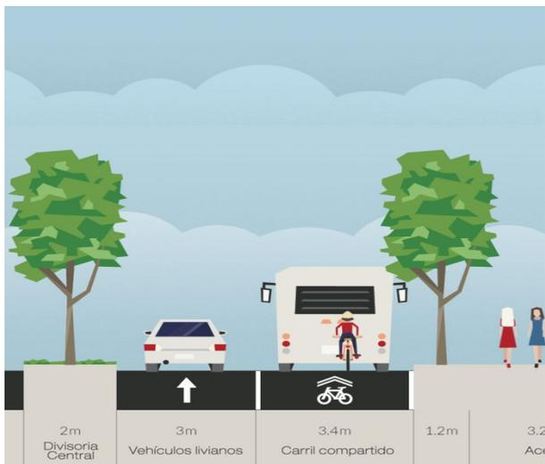
**Imagen 4: Intervención sugerida para secciones de dos canales**
